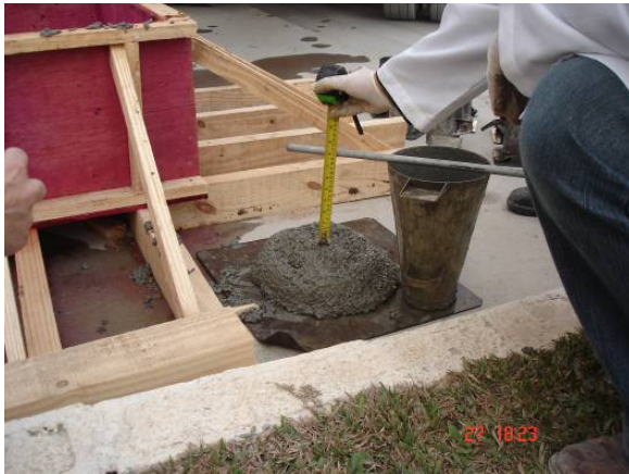
Figura 8 – (a) Abatimento – slump 200mm; (b) concretagem de bloco de aproximadamente 1,0m 3
