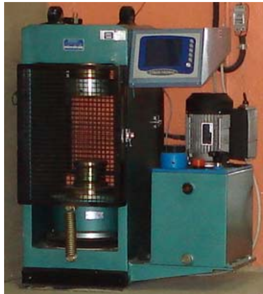
Figura 5 – Prensa utilizada no ensaio de compressão.
