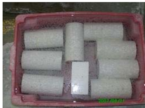
Figura 12 - Cura úmida por imersão.
