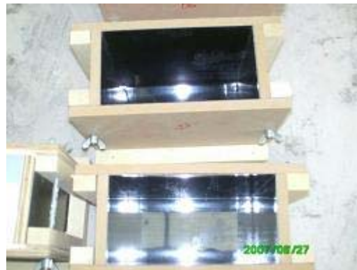
Figura 6 - Fôrma de madeira laminada.
