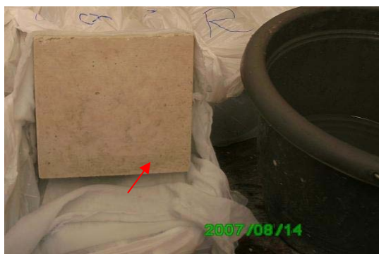
Figura 7 - CP com marcas escuras da chapa resinada.
