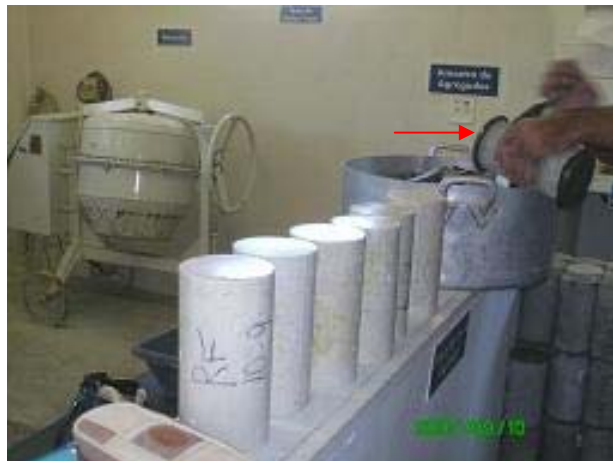
Figura 16 - Capeamento com enxofre.
