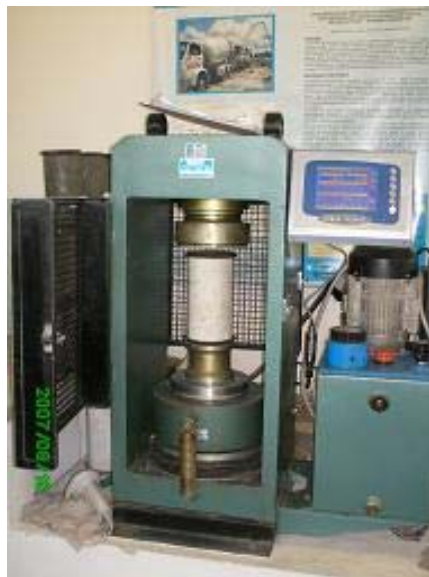
Figura 13 - Ensaio de resistência à compressão.
