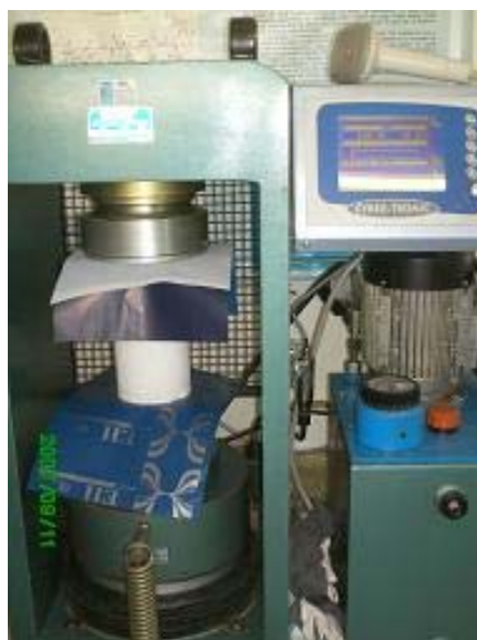
Figura 15 - Rompimento com uso de carbono para verificar a qualidade da retificação.
